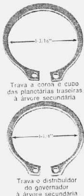
fig. 96 — identificação dos anéis de trava do distribuidor do governador e coroa e cubo das planetárias traseiras
